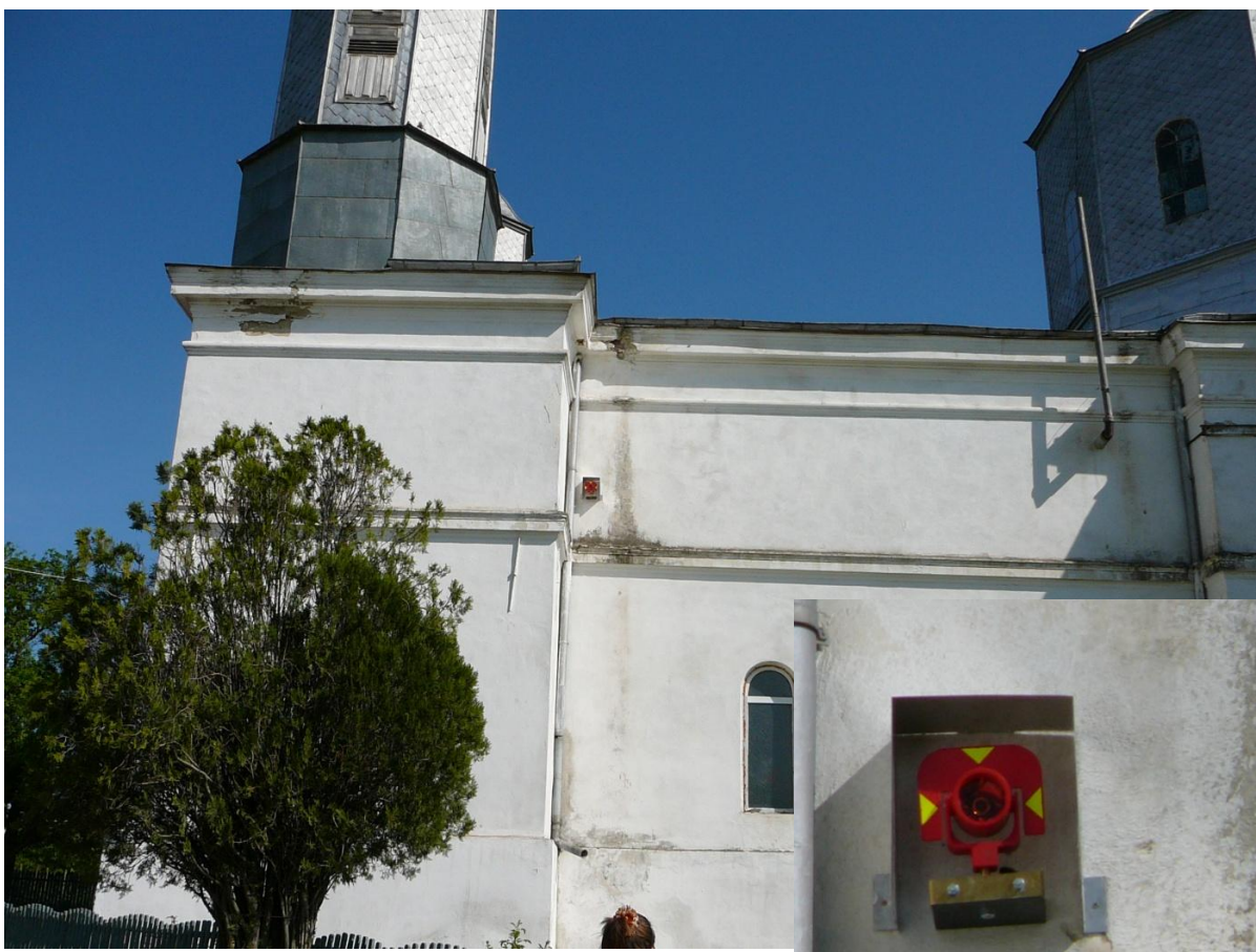
Fig. 3.2.7. Plasarea țintei laser pe peretele bisericii In medalion, detaliu de amplasare
