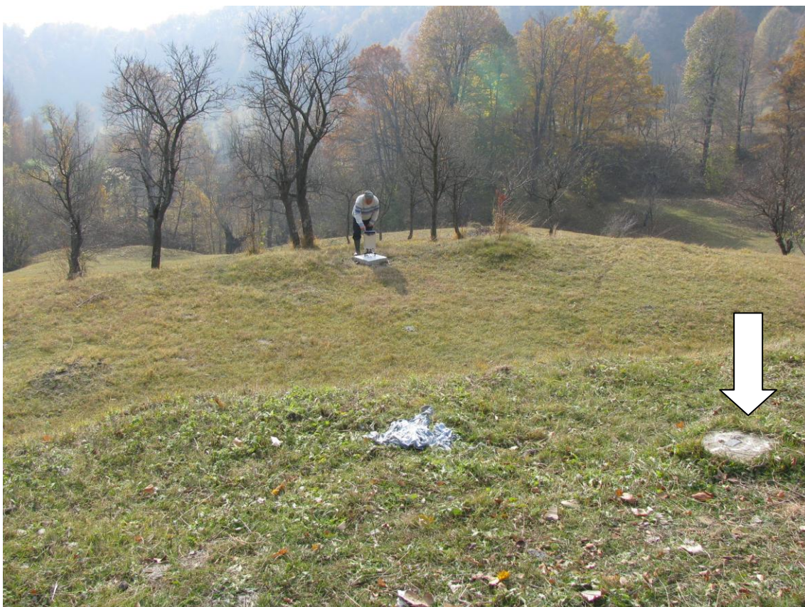
Fig. 2.1.2.24 Gravimetrul CG-5 operat pe plita T016A. Săgeata marcheaza pozitiei vechii plite (T016) deteriorate de constructorii drumului Focsani-Tg Secuiesc
