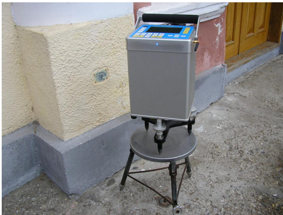
Fig. 2.1.2.4. Gravimetrul Scintrex CG-5 AUTOGRAV operând în stația Adjud din rețeaua gravimetrică națională de referință de ordinul II. Se distinge în imagine plăcuța de identificare a stației, de pe perete și reperul de suprafață care marchează poziția spațială
