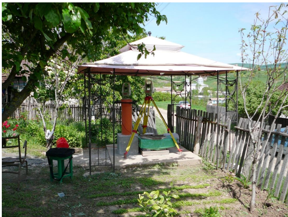
Fig. 3.2.9. Montarea celei de-a doua stații totale, pe un pilastru din beton armat
