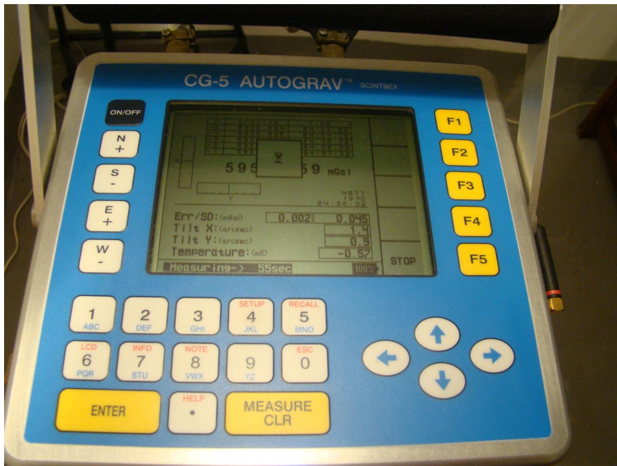
Fig. 2.3.4 Display-ul gravimetrului Scintrex CG-5 AUTOGRAV în timpul înregistrărilor din laboratorul de gravimetrie
