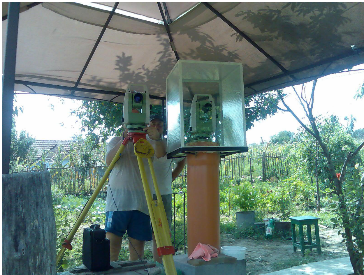
Fig. 3.2.10 Protejarea stației Leica TC 1201 R cu o casetă transparentă
