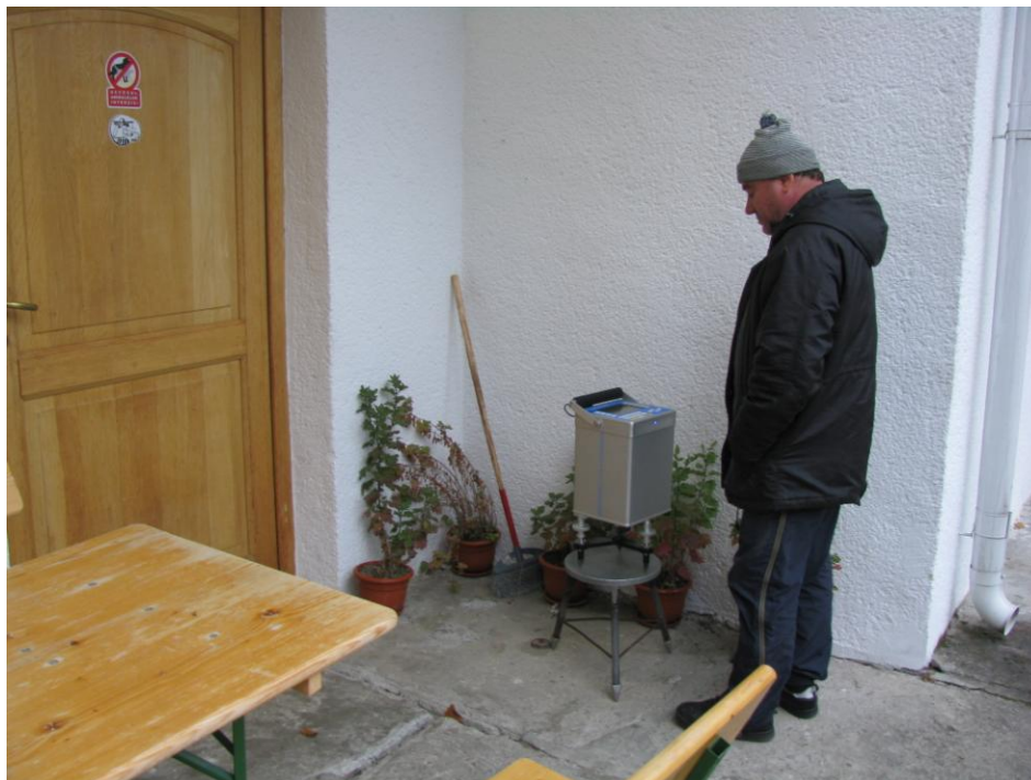
Fig. 2.1.2.8. Gravimetrul Scintrex CG-5 operat în stația Lepșa od. II, baza de referință pentru observațiile din rețeaua națională de sprijin de ordinul II
