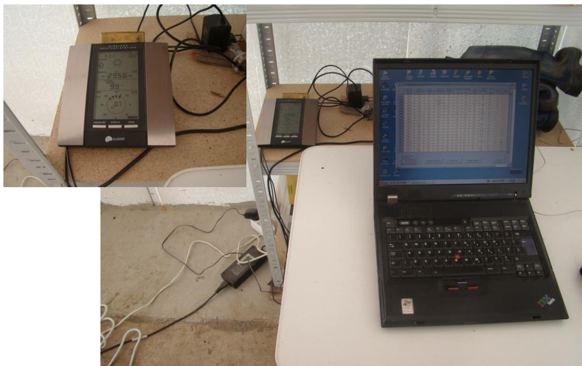
Fig. 3.2.12 Detaliu înfățișând stația meteorologică și notebook-ul care o controlează
