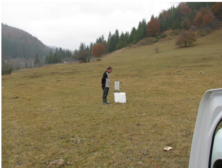
Fig. 2.1.2.9. Gravimetrul Scintrex CG-5 operat pe pilastru P103 Lepșa, baza de referință pentru observațiile din rețeaua națională de geodinamică
