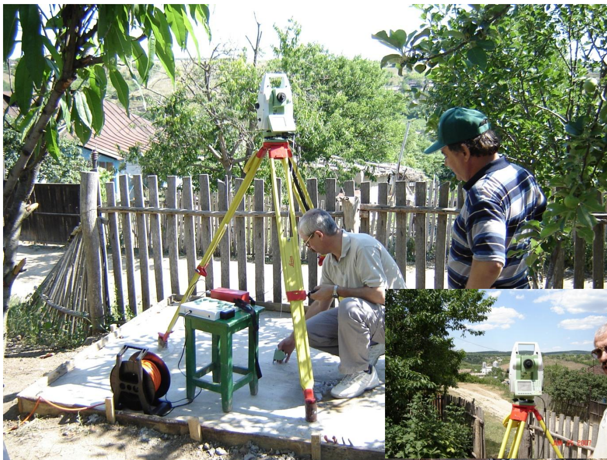
Fig. 3.2.5 Aspect din timpul instalării stației totale Leica TC 1201 la observatorul Baspunar. In medalion se pot vedea școala și biserica, plasate pe celalalt flanc al PCF
