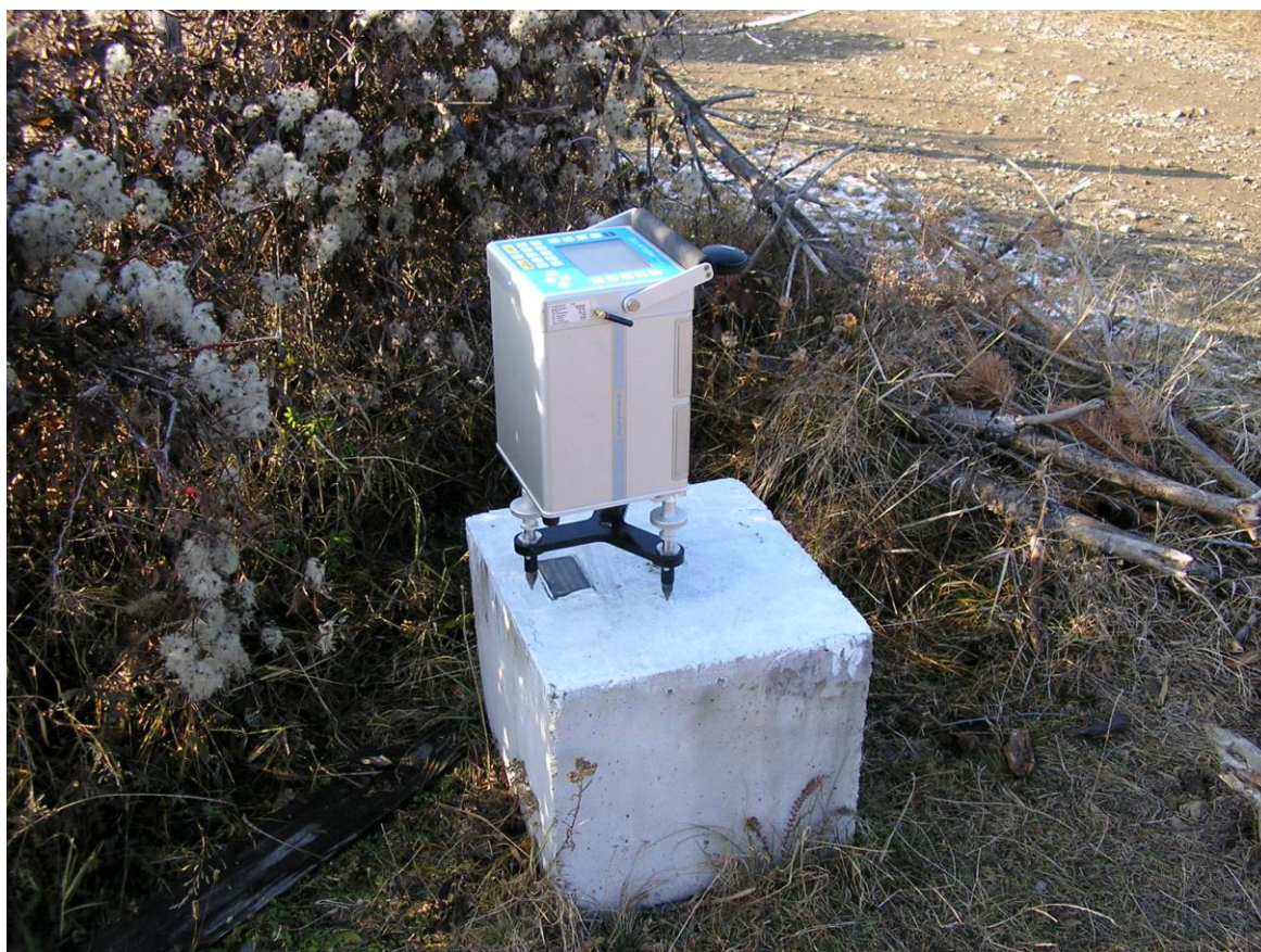
Fig. 2.1.2.2. Gravimetrul Scintrex CG-5 AUTOGRAV operând pe un pilastru gravimetrico-geodetic din Rețeaua națională pentru monitorizarea geodinamică a teritoriului României. Pilaștrii sunt îngropați cca 150 cm pentru a oferi stabilitate metrologică și au pe fața superioară un dispozitiv pentru centrarea forțată a antenelor de GPS după standard CERGOP
