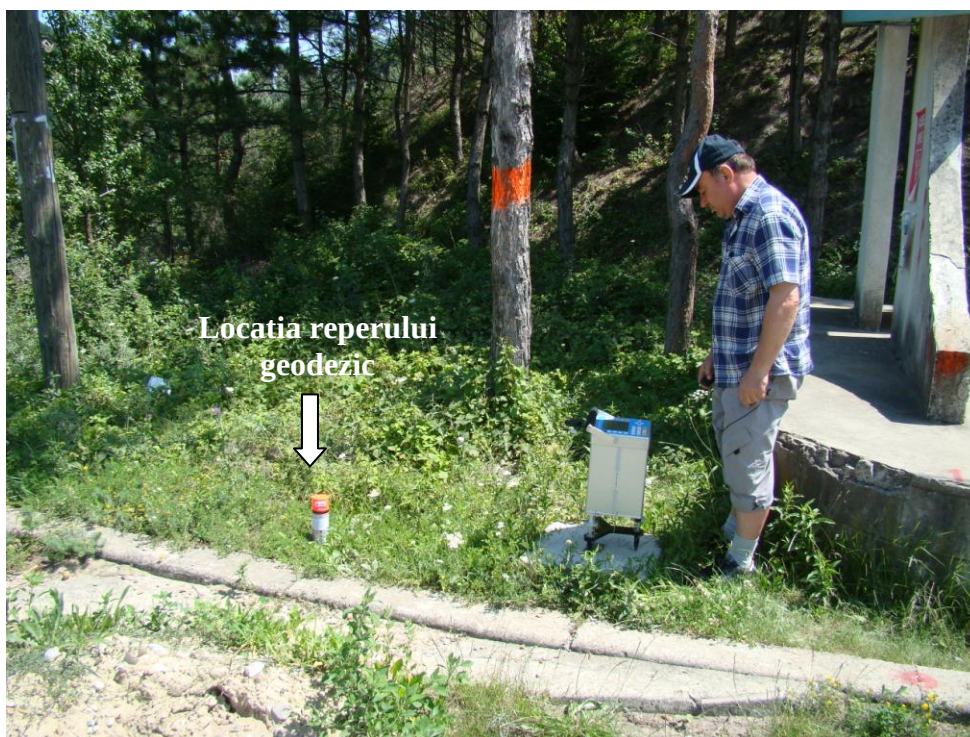
Fig. 2.1.2.3. Gravimetrul Scintrex CG-5 AUTOGRAV operând pe o plită gravimetrică situată alături de un reper îngropat pentru nivelment de înaltă precizie în cadrul micropoligonului de geodinamică nr. 1 Tulnici-Valea Sării-Vrâncioaia.
