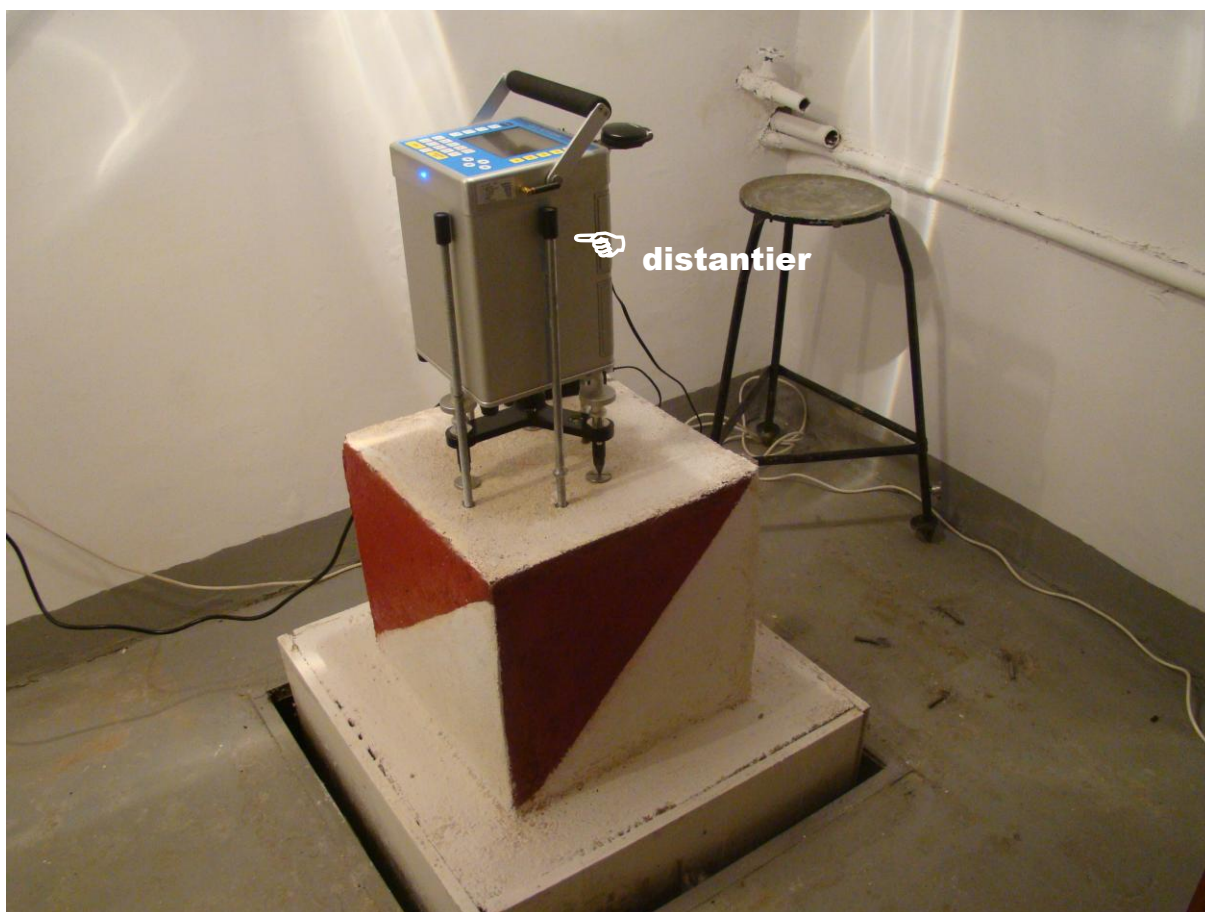
Fig. 2.3.3. Imagine de ansamblu a pilastrului pe care se află amplasat gravimetrul, ilustrând spațiul care îl separă de podeaua laboratorului si distantierii de protecție
