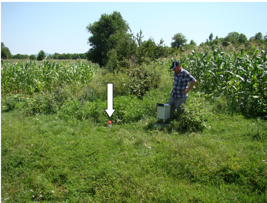
Fig. 2.1.2.18 Gravimetrul CG-5 operat pe plita T009 în campania 2009. Sageata marcheaza locatia reperului denivelment. Statia nu a mai putut fi reocupată în 2011, plita fiind distrusa
