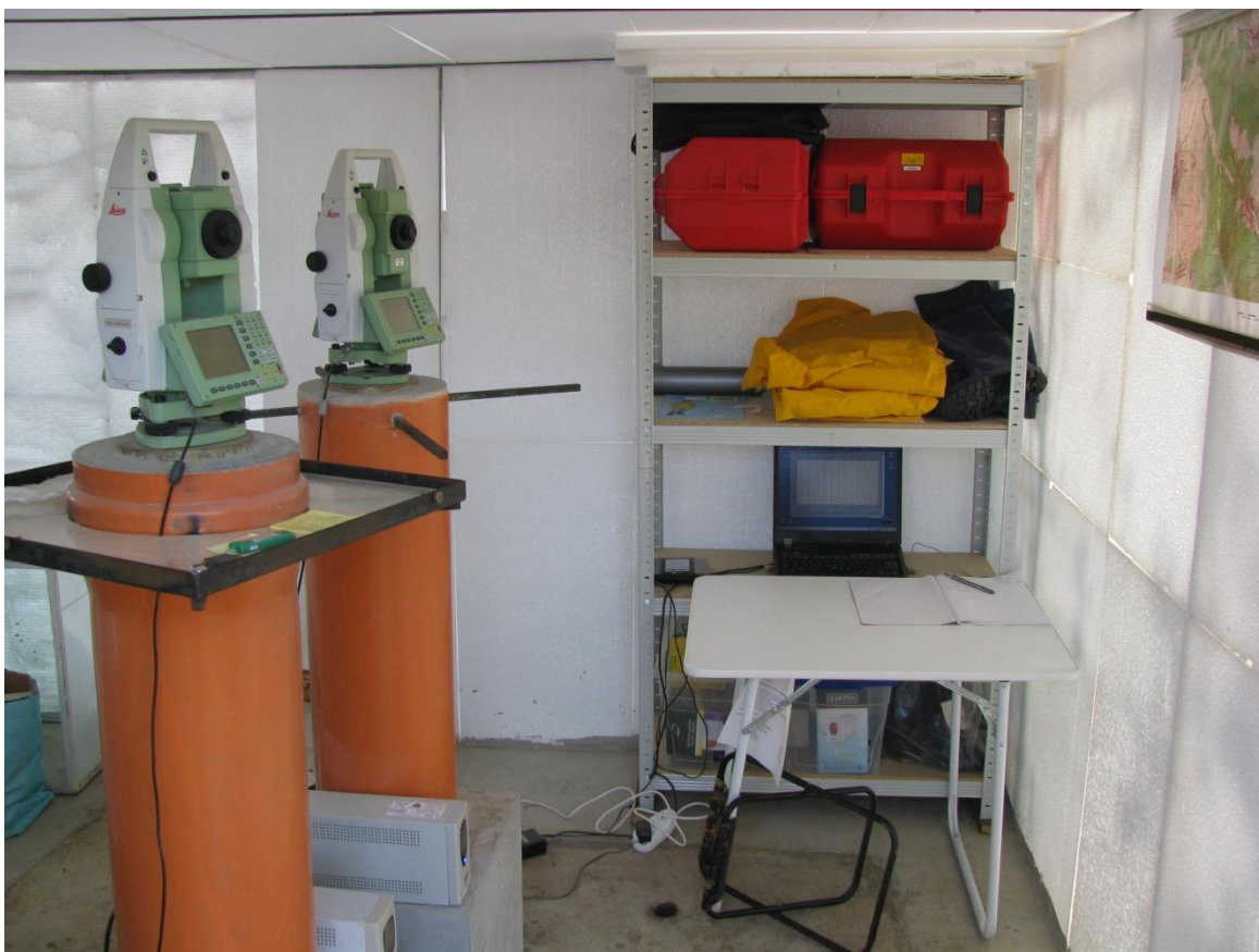
Fig. 3.2.11 Noua construcție, din policarbonat, a observatorului Bașpunar și detaliu interior Se observă amplasarea ambelor stații pe pilaștri stabili din beton armat
