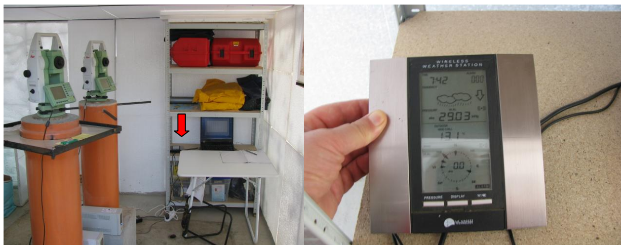
3.1.2 Detaliu din interiorul observatorului: amplasarea unității centrale a stației meteo și parametrii atmosferici înregistrați
