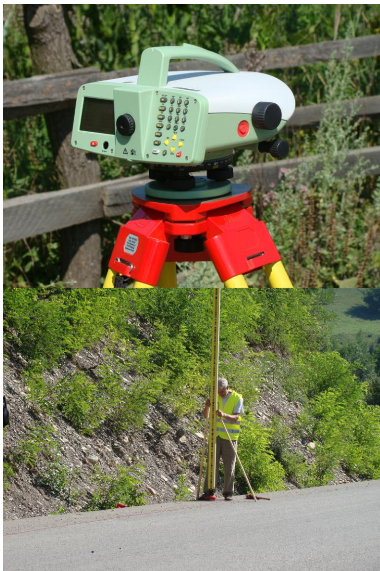
Fig. 3.6 Nivelă de înaltă precizie Leica DNA-03 din dotarea Laboratorului Dinamica Globului Terestru și mira de învar cu cod de bare a nivelei automate Leica DNA-03
