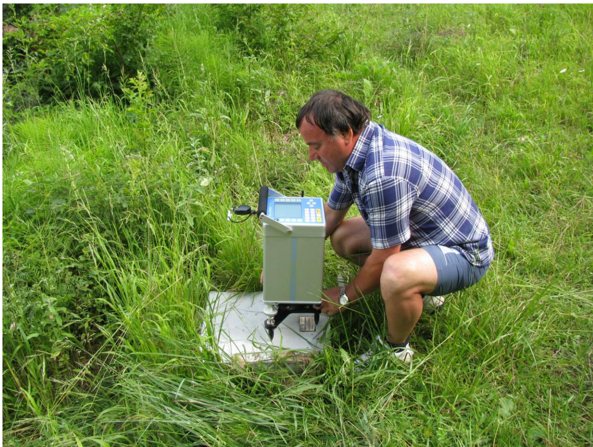
Fig. 3.5. Gravimetrul CG-5 AUTOGRAV operând pe o plită din micropoligonul de geodinamică nr. 1
